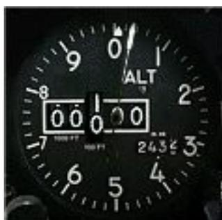
Si le télémètre radar, également appelé radiosonde, n'émet pas, l'altitude affichée sera toujours l'altitude barométrique, c'est-à-dire votre altitude par rapport au niveau de la mer. Falcon 4.0 ne modélisant pas les pressions atmosphériques, cette altitude sera toujours parfaitement juste.
