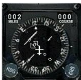
Sur le HSI, le cap se lit en regardant en haut du plateau mobile. Ainsi, dans l'image ci-dessus, l'appareil pointe vers le 135, grosso modo.
